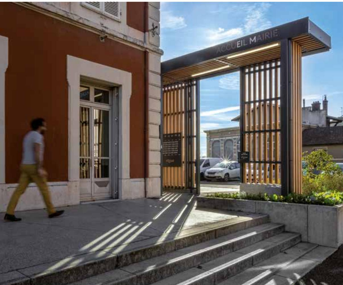
◀ Située sur la façade ouest, la nouvelle entrée de l'accueil de la mairie permet, d'une part, de régler le problème de sécurité d'accès au bâtiment, d'autre part, de protéger les bureaux d'un ensoleillement excessif grâce aux brise-soleil en mélèze massif.
