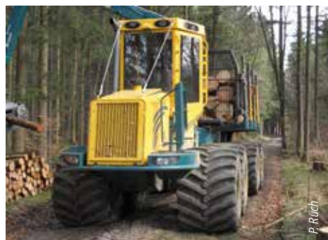
Porteur 8 roues équipés en pneumatiques de 940 mm, les plus larges actuellement disponibles
